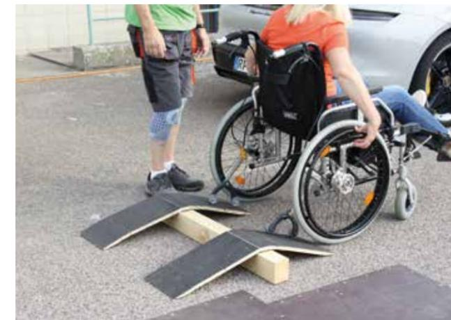
Die Erprobung einer fertigen Rollstuhlrampe
